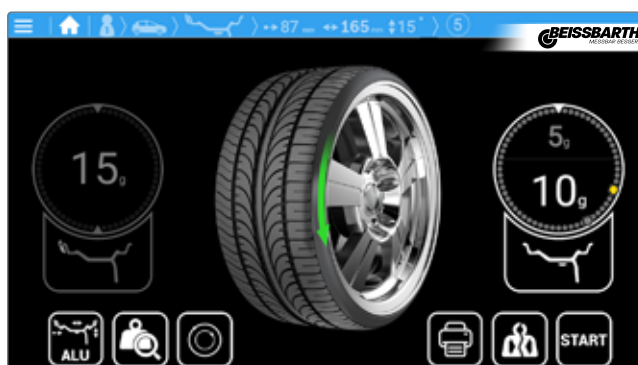
Versteckte Gewichtsverteilung hinter Speichen (SPLIT Programm/ASD-Funktion)
