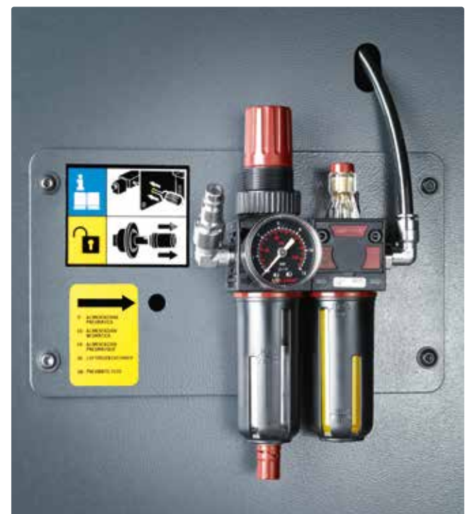
Servicebox: Manuelle Entriegelung und Druckluftanschluss an der Wartungseinheit (nur beim pneumatischen Flansch)
