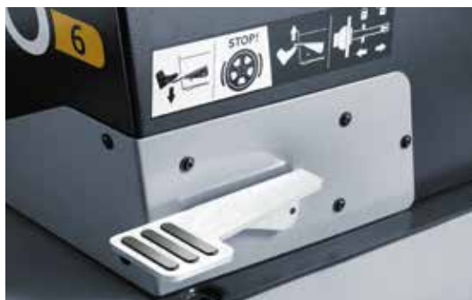
Neue Pedalfunktion: Nach unten: Blockiert Welle/ Rad. Hoch: löst/spannt den Pneumatikflansch
