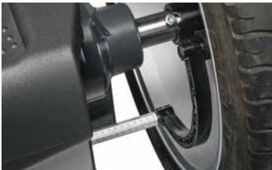
Elektronischer Datenarm ermittelt Felgenabstand/-durchmesser und die Position für die Klebegewichte
