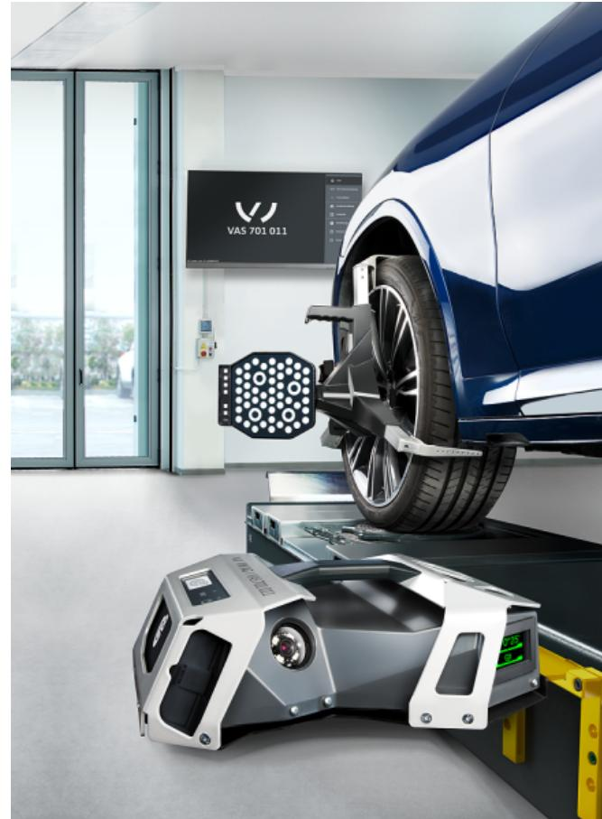
Achsmessgerät VAS 6767A | für
